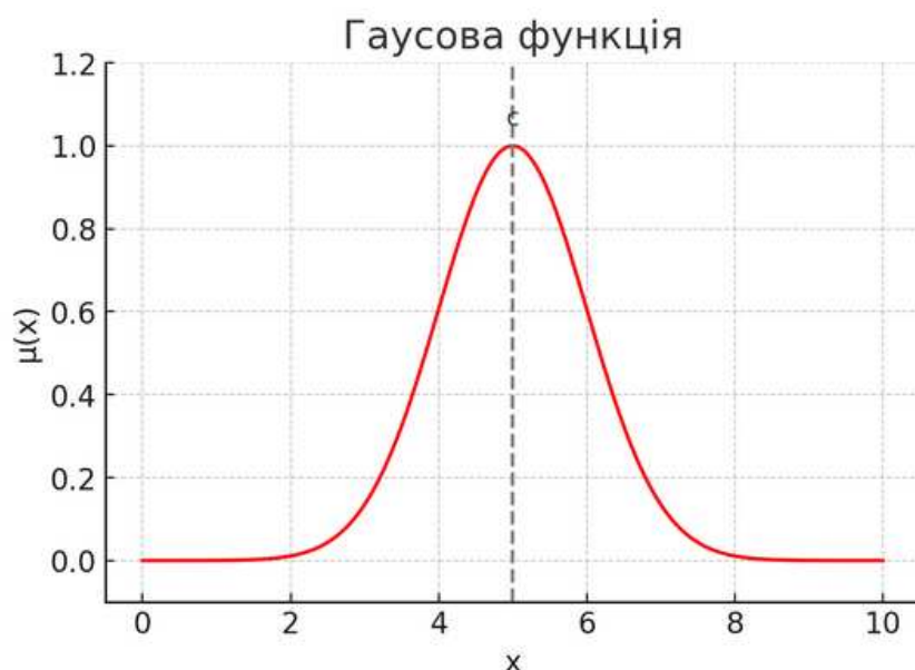
Рис. 2.6. Приклад гаусової функції належності
