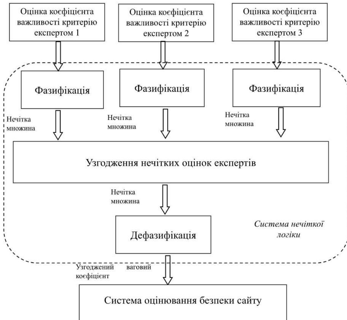
Рис. 2.3. Структурна схема системи нечіткої логіки оцінювання коефіцієнту важливості критерію з врахуванням невизначеності та неузгодженості думок експертів.
